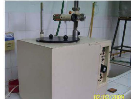
Bomba calorimétrica p/determinación de PCS
